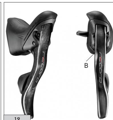
Introducir el cable del desviador (longitud 1,600 mm -  $\varnothing$  1,2 mm) en la parte inferior del mando (B - Fig. 19).
